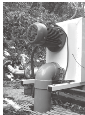
「風のがっこう・京都」の近くに設置された小水力発電装置
