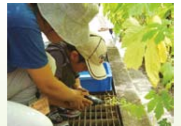
放射温度計により温度を測定している様子 リサイクル研修ステーション(木津川市)
